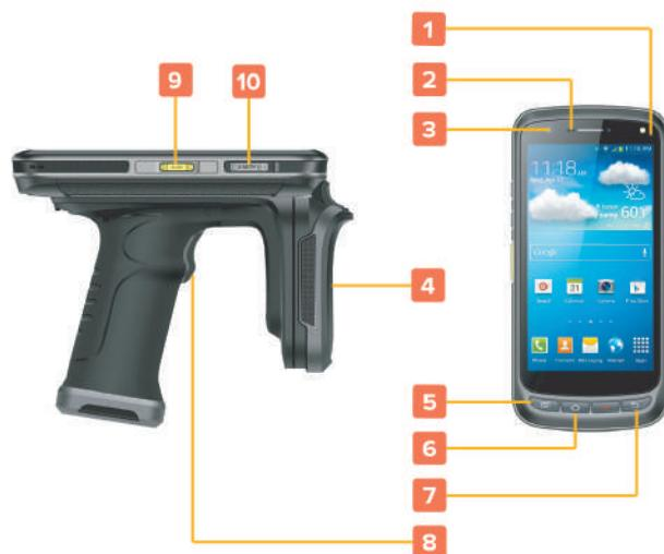
C72 стандартная конфигурация: 2D штрих-код модуль, сканирующий модуль UHF, Камера (передняя), 4G, GPS, Bluetooth, WIFI, 2G, RAM, 16G ROM.
